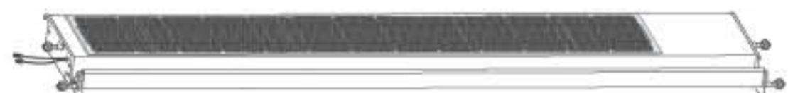
pour pergola de largeur > 300 cm et ≤ 425 cm lames avec 2 panneaux Type A de 25 W (total lame 50 W) /
